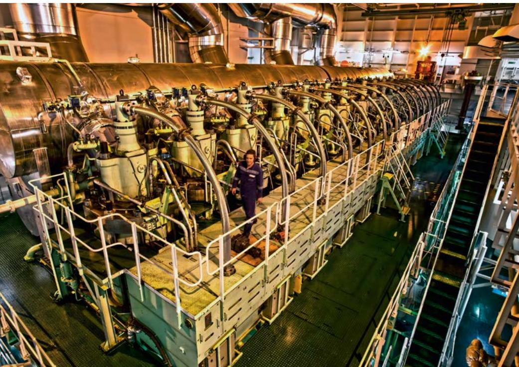
*Der gegenwärtig stärkste je gebaute Motor. 14-Zylinder mit je einem Meter Durchmesser in einer Reihe. Es ist ein finnischer Wärtsilä von 108 000 PS, der bei voller Geschwindigkeit bloss eine Drehzahl von 90 Umdrehungen aufweist. Er hat ein Gewicht von 2500 Tonnen, ist 23m lang und fast ebenso hoch.*
